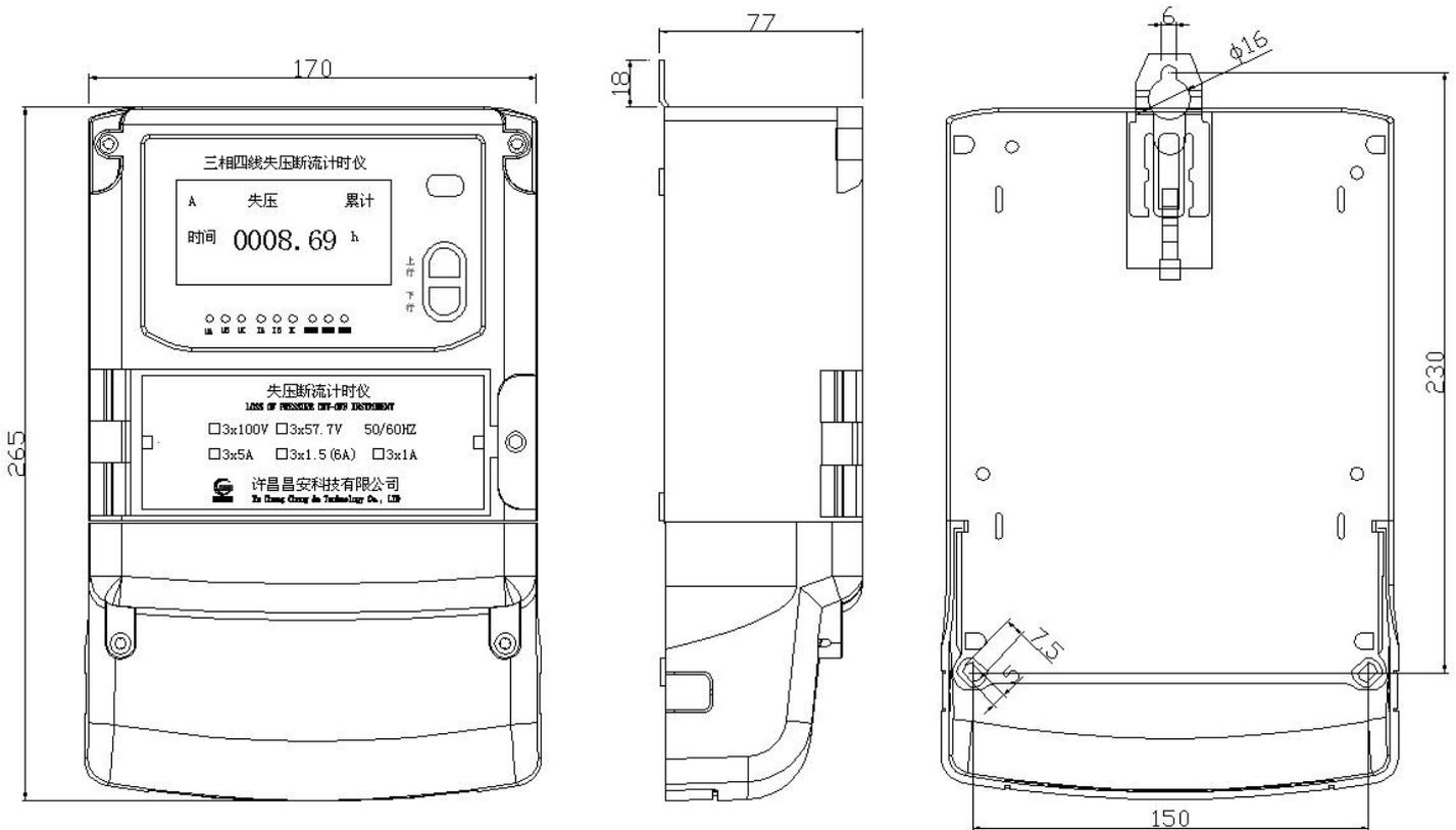
图2 安装尺寸图
