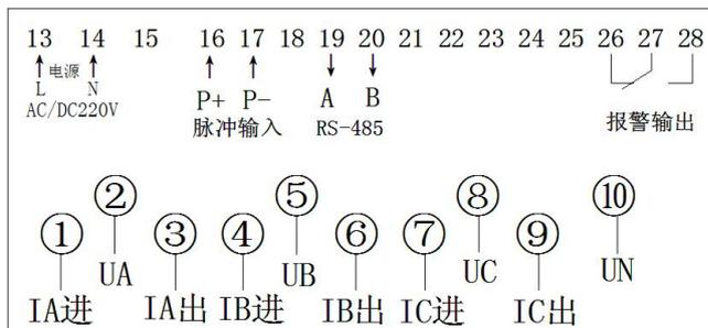
①三相三线失压断流计时仪接线图(JJSY-3BS-FK2)
