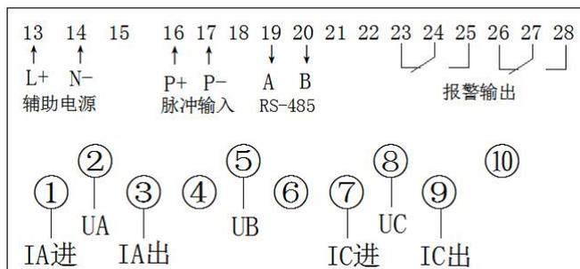
②三相四线失压断流计时仪接线图(JJSY-3BT-FK2)
