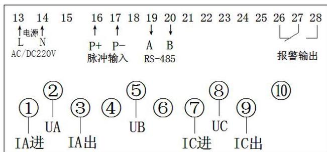
②三相四线失压断流计时仪接线图(JJSY-3BT-F)
