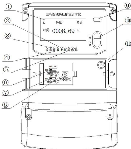
图 2 失压断流计时仪外观图
